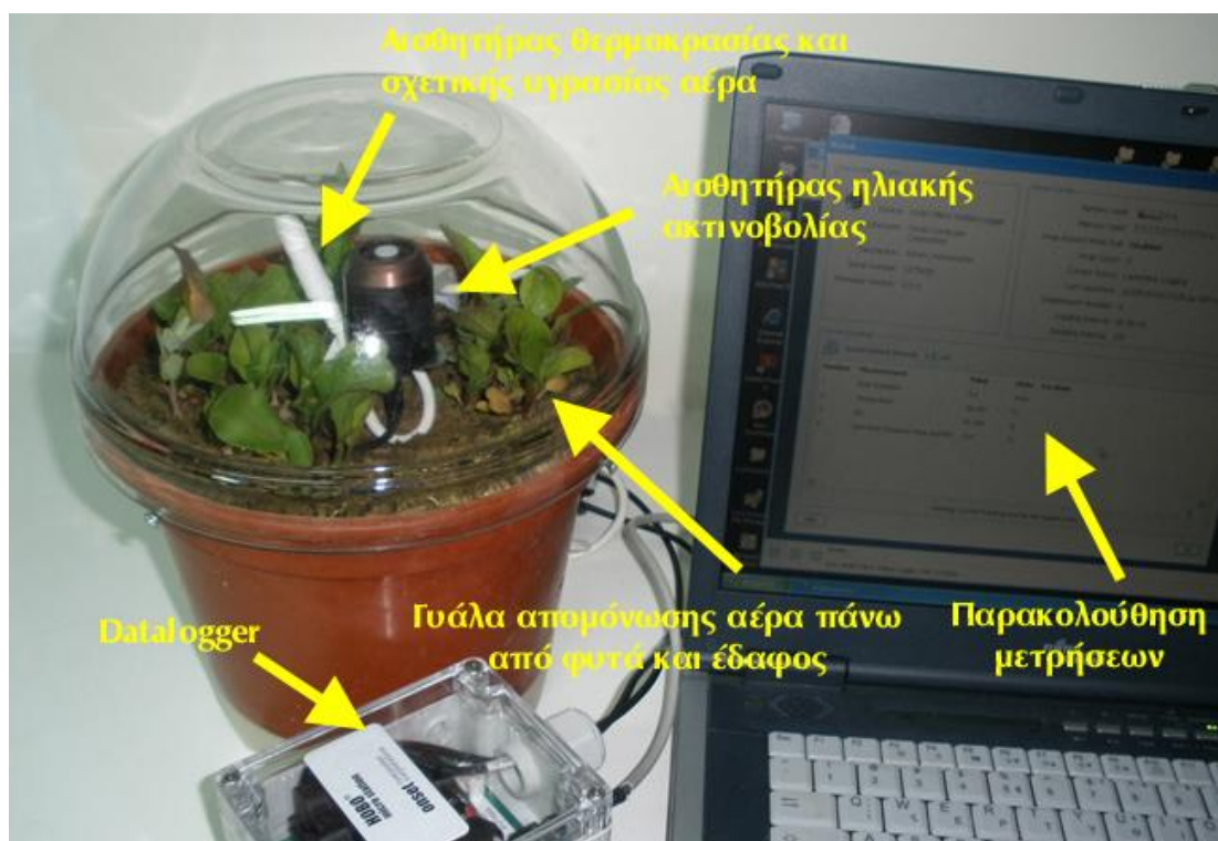
Σχήμα 4. Απλή πειραματική διάταξη για κατανόηση της εξατμισοδιαπνοής
